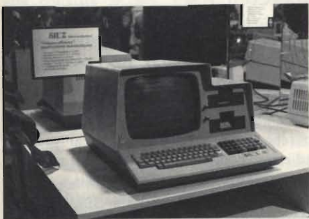
Fig. 5 - Il nuovo Canon CX 1 non è dotato di operating system standard ma la sua memoria RAM può raggiungere 128 kbyte, l'alta qualità della visualizzazione sullo schermo ed il prezzo quasi senza concorrenza gli riservano certamente un buon successo.
