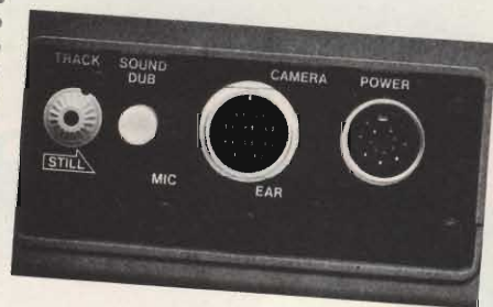
Il piccolo pannello laterale con gli attacchi per la camera, l'alimentatore e gli altri comandi.
