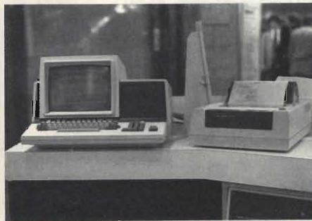
Fig. 4 - Un nuovo computer francese che aspira all'esportazione: il SIL'Z della Léanord. Si tratta di un'apparecchiatura potente venduta ad un prezzo equivalente a circa 6 milioni di lire che funziona con il CP/M e che troverà un campo di applicazioni molto vasto ma che sembra particolarmente adatto all'insegnamento.
