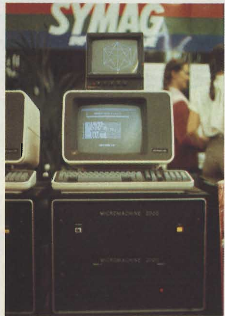
Fig. 2 - La Micromachine 2000 può essere equipaggiata di 2 floppy da 8" 512 Mbyte con cartridge per back-up. In monoutente fa uso del CP/M o dell'//OS mentre in multiutente (fino a 8) usa l'MP/M o l'OASIS. Il bus S100 permette facilità di espansione, ad esempio con l'inserzione di una carta grafica ad elevata risoluzione.
