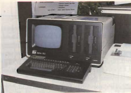
Fig. 3 - Il SIGMA 850, nuovo personal computer francese prodotto dalla IPS. Può essere equipaggiato con 2 mini floppy da 310 kbyte, da due floppy da 950 kbyte o anche da un disco rigido Winchester da 20 Mbyte. È destinato alle applicazioni gestionali e la società francese sottolinea la globalità e la completezza del servizio offerto.
